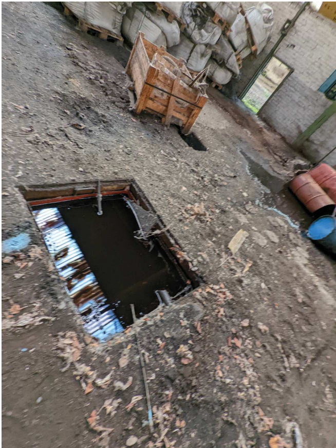
Trous dans le sol sans système anti chute
